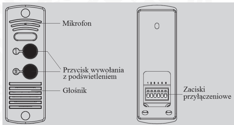
Rys. 2. Opis kasety zewnętrznej
